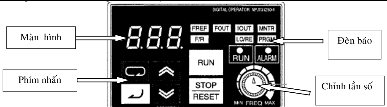
Hình 2.19a Mặt hiển thị và phím lập trình của biến tần
